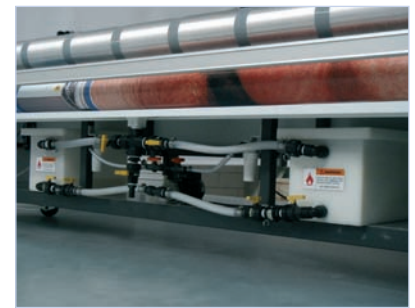
Optional erhältliches "Dual Tank System" für einfache und saubere Umstellung des Laminattypes.
